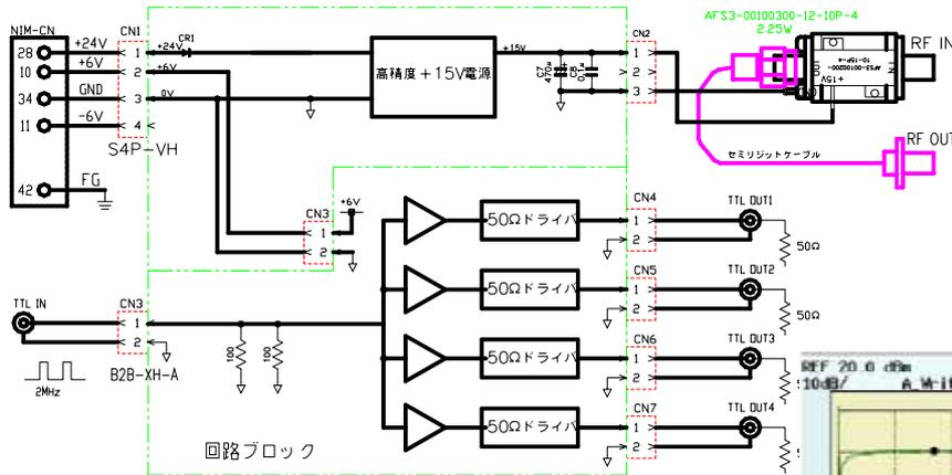
AFS3-00100300-12-10P-4 は入力電源15V125mA=1.9W を消費するので、銅板によってヒートシンクに接続し、伝導放熱をしています。
